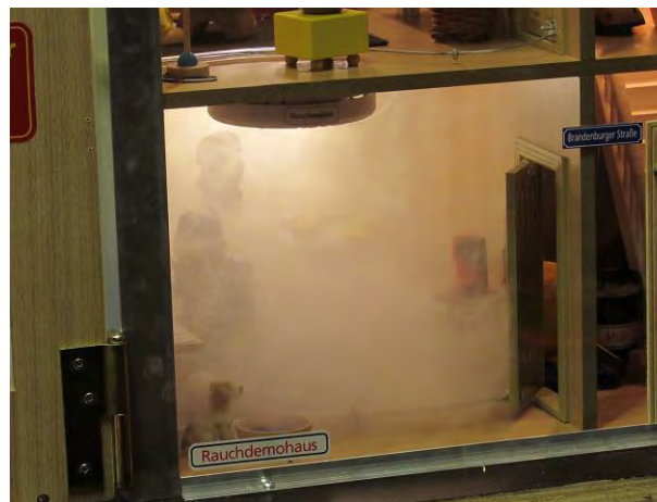
Mit der Nebelmaschine lassen sich einzelne Räume oder das komplette Haus „verrauchen“. Enthalten sind drei Lüfter zum Entrauchen – um den Einsatz der Lüfter zu demonstrieren oder um die Räume für die nächste Vorführung wieder rauchfrei zu machen.
